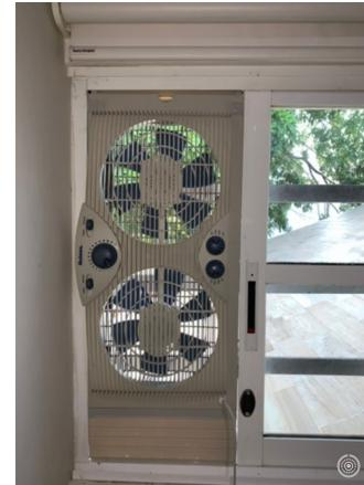
Se cierra la ventana y encendiendo el ventilador con la dirección del aire hacia afuera, se convierte la habitación en una HABITACIÓN DE PRESIÓN NEGATIVA. Se pueden utilizar otro tipo de ventiladores colocándolos a la ventana abierta. Es importante que cualquier otra ventana en la habitación también este cerrada.
