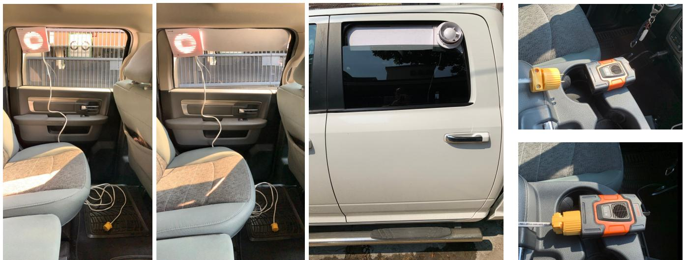
Aun cuando la unidad esté parada, el extractor logrará la renovación del aire en el interior. Si la unidad cuenta con aire acondicionado, el extractor también facilitará la renovación del aire en el interior. Se puede argumentar que se gastará más combustible para generar el aire frío pero a cambio mitigaremos los contagios y se dará seguridad y confianza al usuario.
