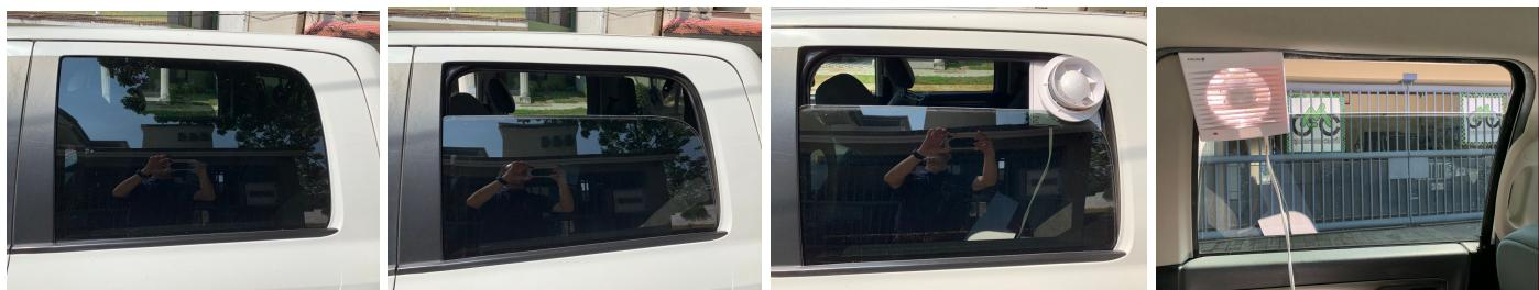
El cable conectado al extractor se coloca por debajo de los asientos hasta llegar a la consola del chofer. En la consola del chofer conectamos el inversor de corriente a la toma de 12 volts y posterior a ello le conectamos el cable que va al extractor. Una vez que la toma de corriente de 12 volts suministre corriente, el extractor comenzará a funcionar y a sacar el aire del interior de la cabina.
