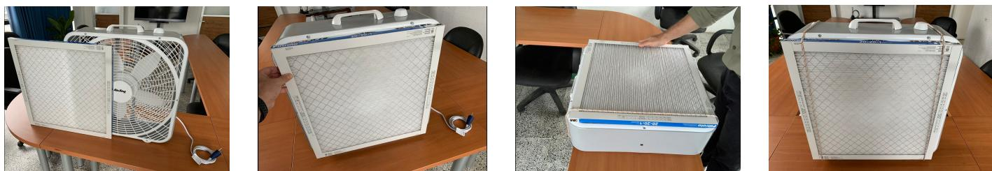
El ventilador y el filtro HEPA tienen 20 pulgadas por lado cada uno. Colocamos el filtro HEPA del lado de la salida del aire del ventilador teniendo en cuenta la flecha de dirección del aire (ver foto arriba).
